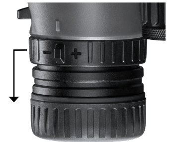
Fig. 6 Dioptría de calibración de la imagen. Jale el anillo hacia la copa ocular para desbloquear para hacer el ajuste.
