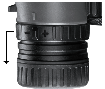
Fig. 6 Diottrie per la calibrazione dell'immagine Spingere l'anello verso il paraocchio per sbloccare la regolazione.
